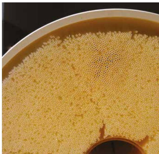
Ultrafiltracijski modul – čelna stran – surova voda vstopa v kapilarne cevke (premera 0,9 mm)
