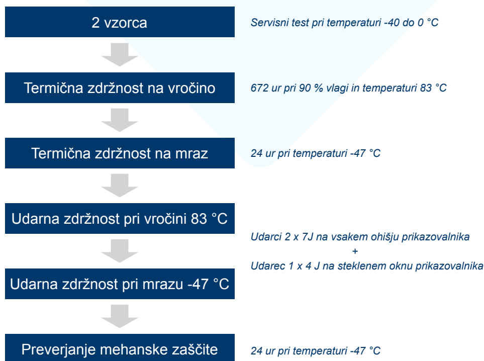
Slika 1: Testni protokol standardnih prikazovalnikov BEKA
