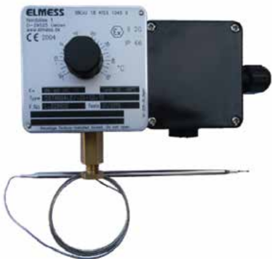
Slika 2: Z Ex-termostatom DSTR60 lahko direktno krmilimo Ex-grelce s tokovno porabo do 16 A
